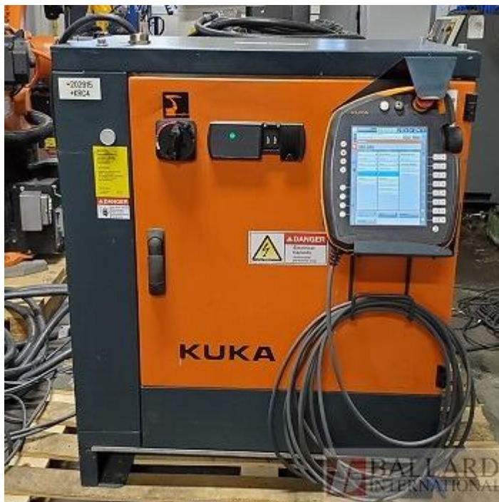
Figura 2. Painel elétrico de comando, unidade de controle e programação, Kuka KR 120 R2900 EXTRA KRC4
